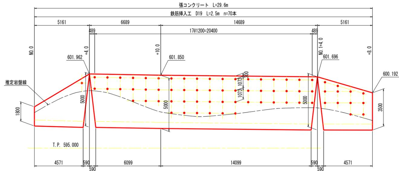
鉄筋挿入工 S=1:4
